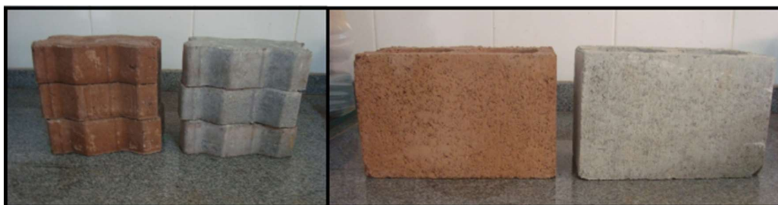
Figura 62: Materiais com (blocos marrons) e sem a adição de rejeitos de mineração. Fonte: Fiorotti, 2016.
