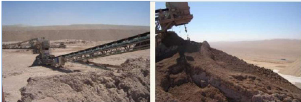
Figura 58: Disposição de rejeito filtrado em Mantos Blancos, Chile. Fonte: Guimarães, 2011.
