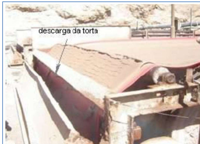
Figura 59: Torta gerada pela filtragem de rejeitos da mina de cobre em Mantos Blancos, Chile. Fonte: Guimarães, 2011.
