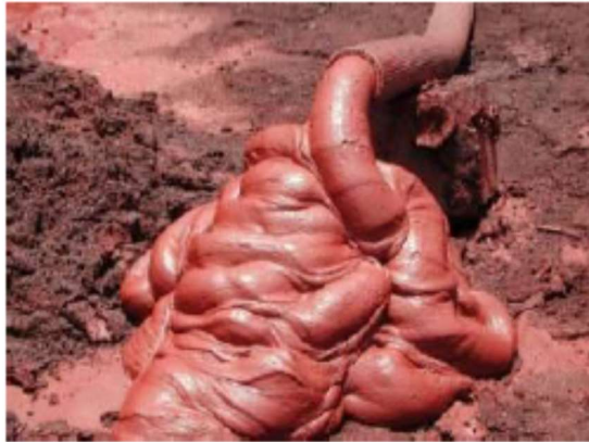
Figura 56: Pasta de rejeito de minério de ferro. Fonte: Guimarães, 2011.
